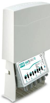
Amplificador de mástil de 1 entrada (III+DAB+UHF) con ganancia de 25dB y nivel de salida hasta 116dB $\mu$ V en la banda UHF, amplificación separada VHF/UHF, ajustes de ganancia independientes (0-15dB) para cada banda y baja figura de ruido. Tecnología T2 con filtro integrado para eliminar interferencias 5G a 694MHz.
